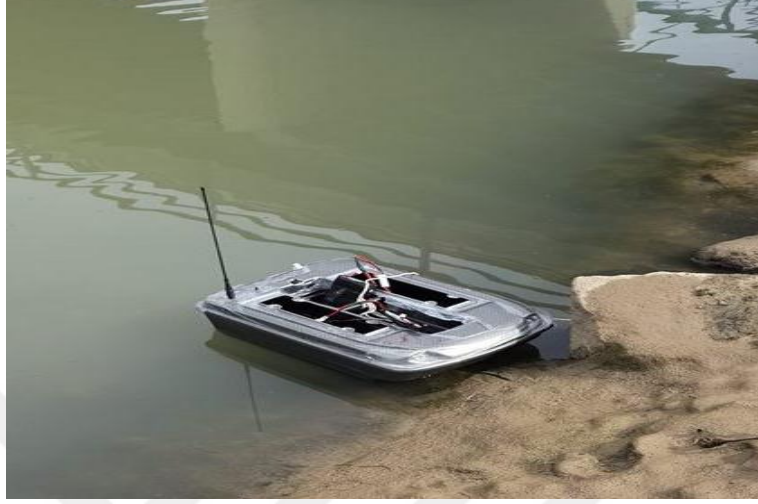
Şekil 3.2. Akustik sonar’ın bağlı olduğu uzaktan kumandalı bot
