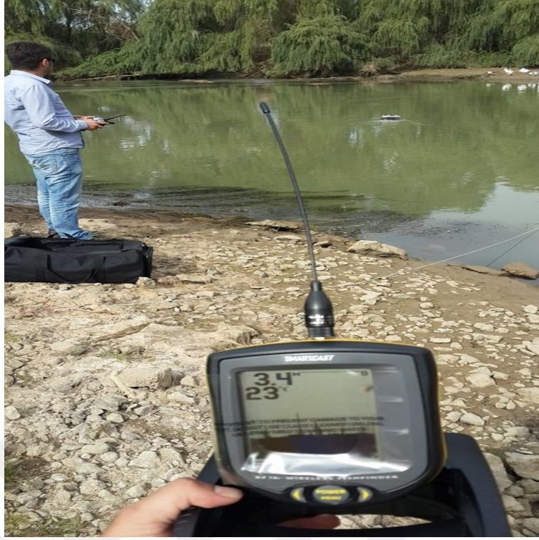
Şekil 3.4. Bot ve sonar ile derinlik ölçümü
