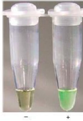
Şekil 1. 11. Kalsein kullanıldığında negatif (solda) ve pozitif (sağda) reaksiyonun gün ışığında belirlenmesi (Tomita et al., 2008a).
