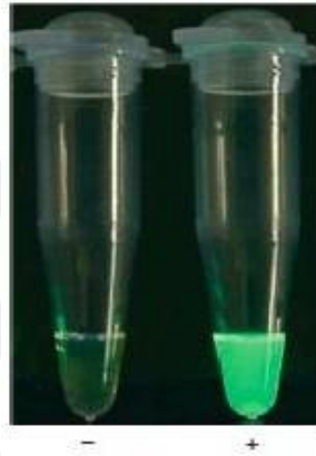
Şekil 1. 10. Kalsein kullanıldığında negatif (solda) ve pozitif (sağda) reaksiyonun bir el UV lambasıyla (dalga boyu: 365 nm.) belirlenmesi (Tomita et al., 2008a)
