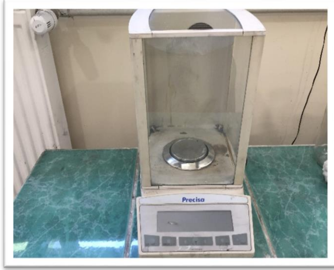
Şekil 4.2. Tozların oranlarının belirlenmesinde kullanılan Precisa marka hassas terazi.
