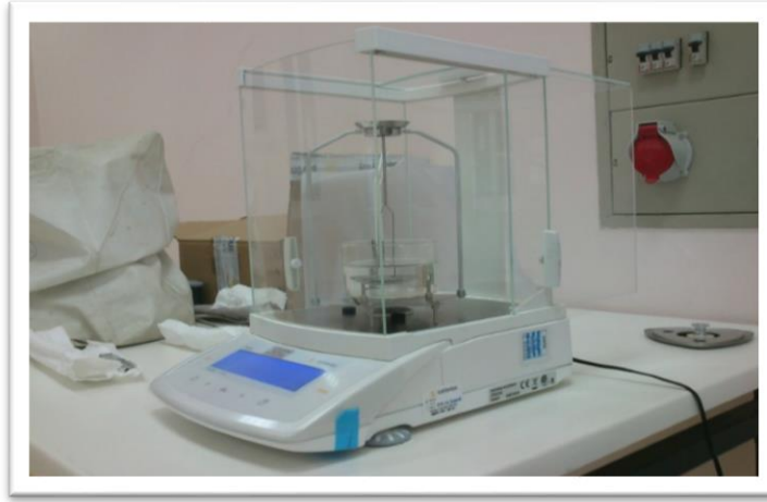
Şekil 4.10. Yoğunluk ölçümlerinde kullanılan Sartorius marka hassas terazi
