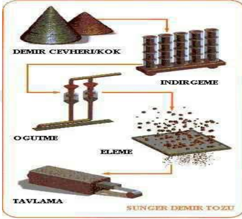
Şekil 3.11. Kimyasal metodla demir tozu imalatı [74].
