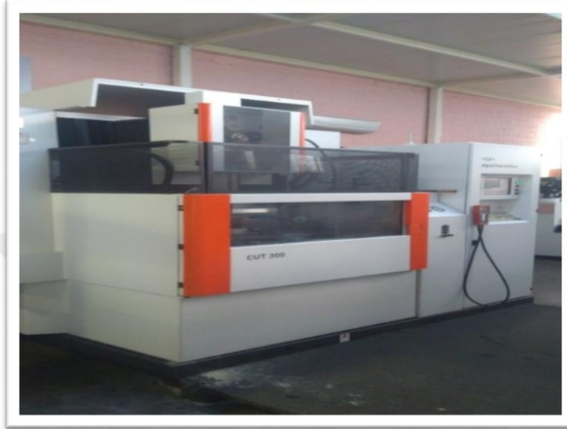
Şekil 4.8. Numunelerin kesildiği CNC Tel Erezyon Tezgâhı
