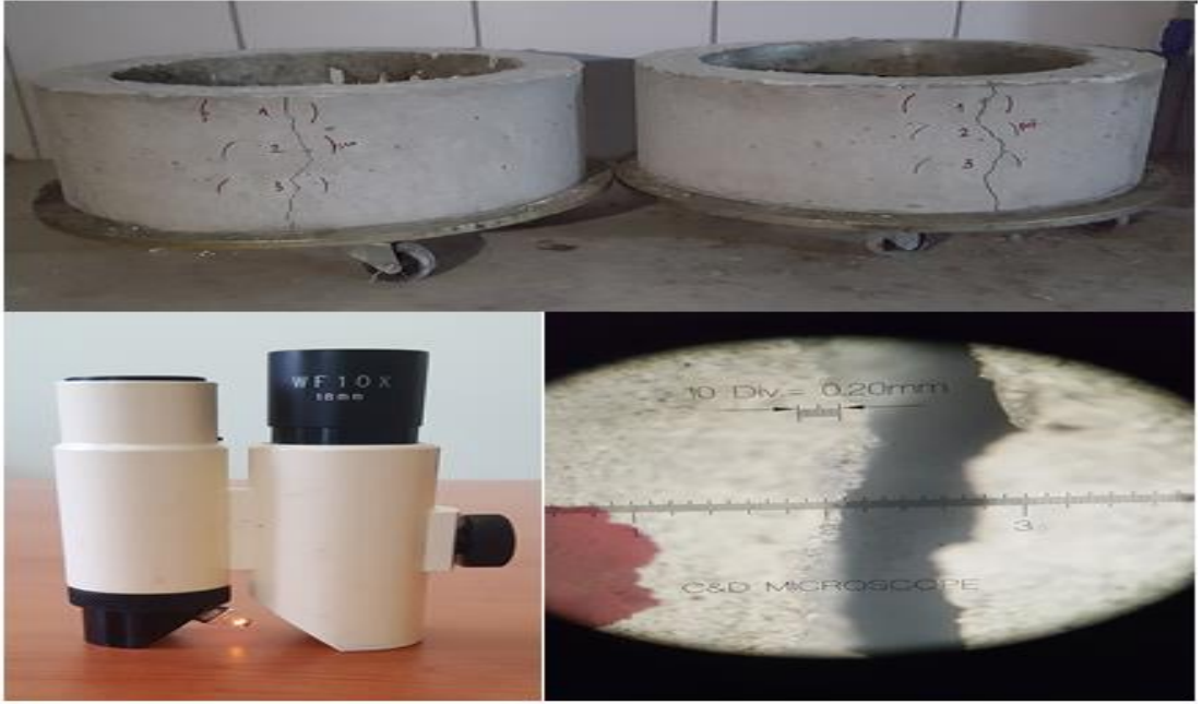
Şekil 3.20. Halka deneyi uygulama aşaması
