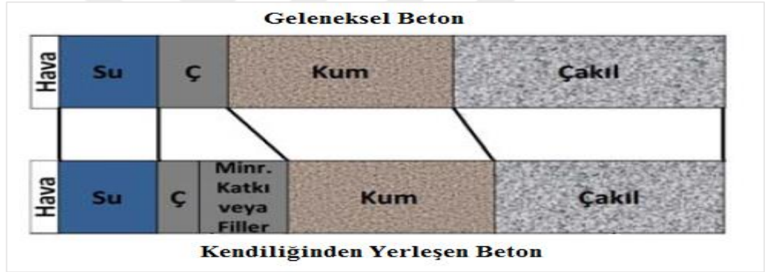
Şekil 2.4. Geleneksel beton ve KYB'nin malzeme hacmi karşılaştırması [27].
