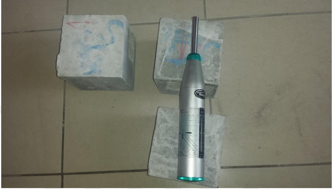
Şekil 3.13. Schmidt test çekici uygulaması
