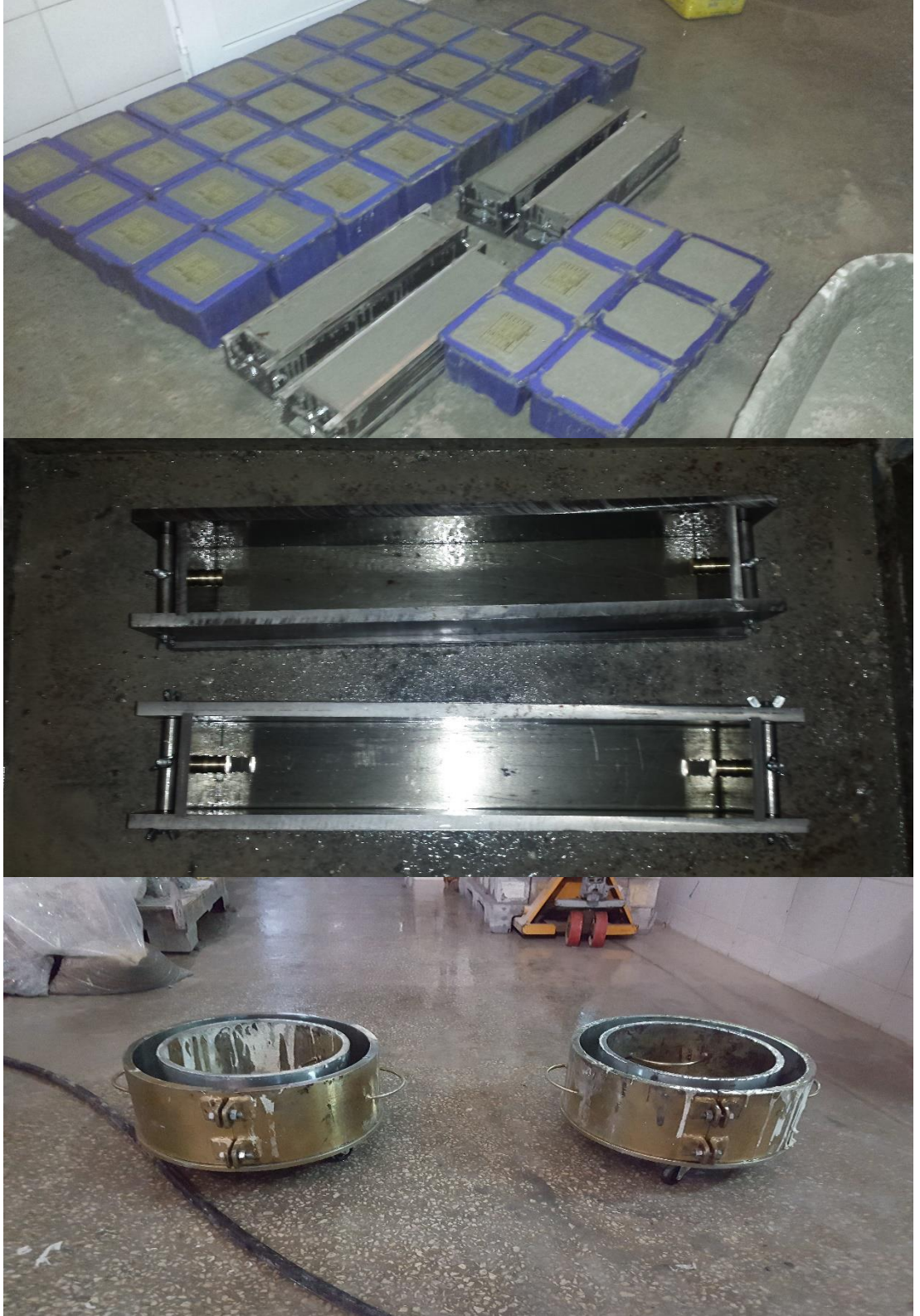
Şekil 3.7. Basınç, eğilme ve rötre deneylerinde kullanılan kalıplar
