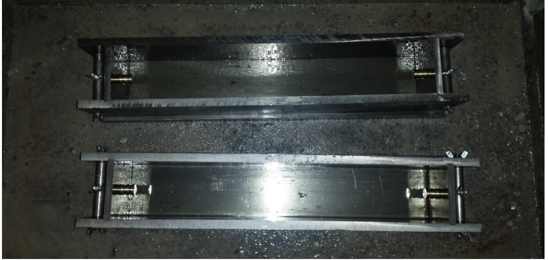
Şekil 3.14. 100*100*500 mm boyutlarında pimli prizmatik kiriş numunesi kalıbı
