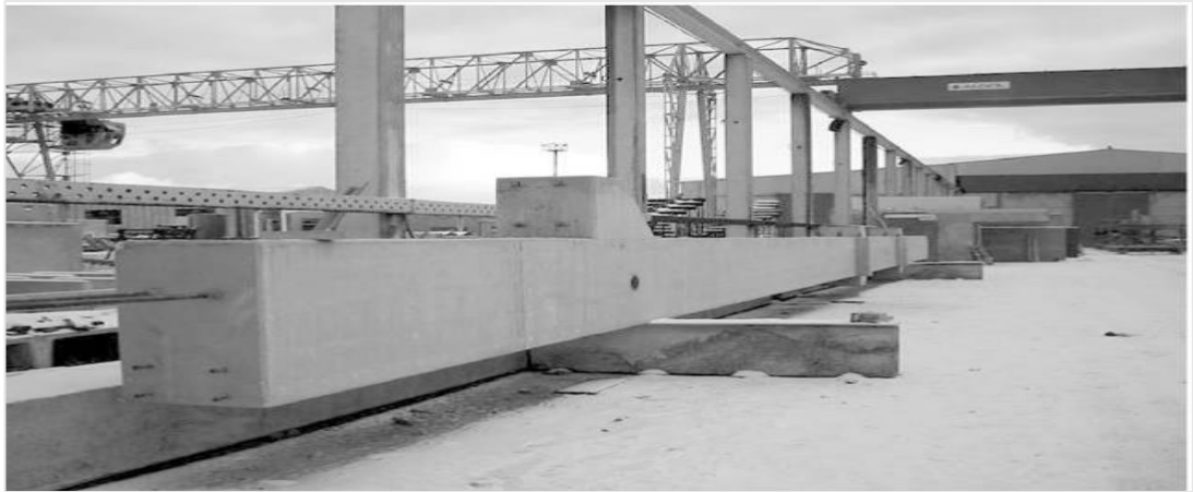
Şekil 2.1. KYB'den üretilmiş prekast bir kolon [20].
