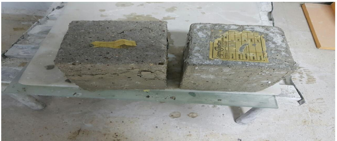
Şekil 4.19. 180 gün sülfat çözeltisinde IKÇ’ne maruz bırakılan numuneler
