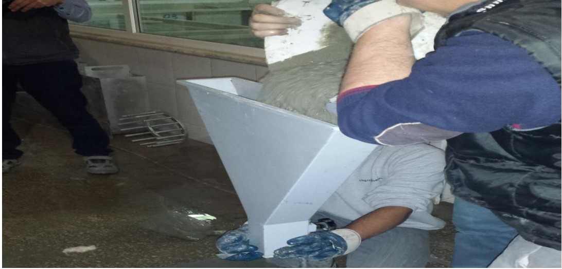
Şekil 3.9. V hunisi deneyi yapılışı
