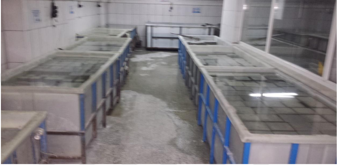
Şekil 3.12. Su küründe bekletilen KYB numuneleri
