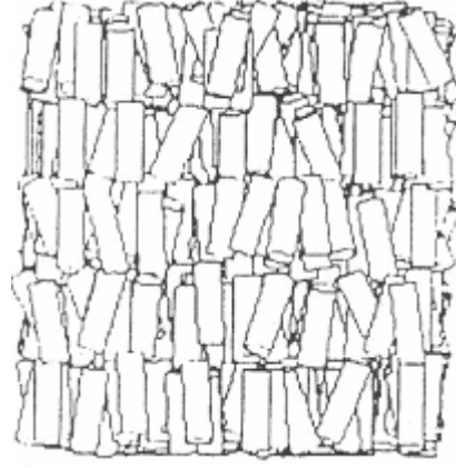
Şekil.1.5. Smektik sıvı kristal fazın yapısı.
