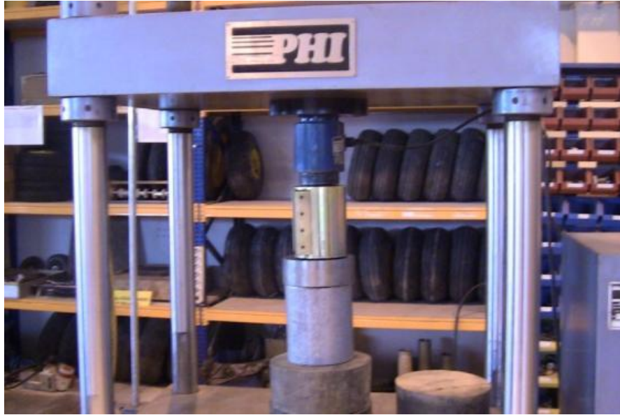
Şekil 4.14. Statik Basınç Testi Düzeneği (Dikey Konum)
