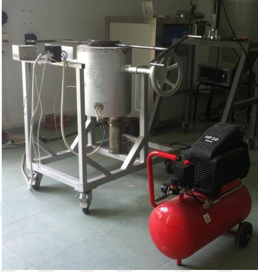
Şekil 3.8. Vakum infiltrasyon düzeneği
