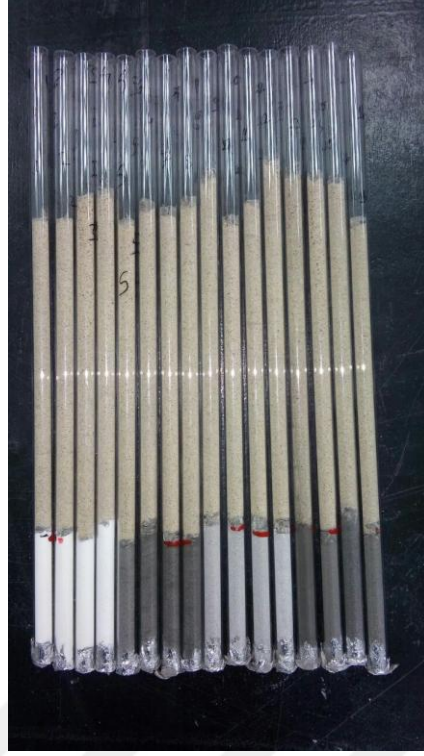
Şekil 3.5. İnfiltrasyonda kullanılan cam kalıplar
