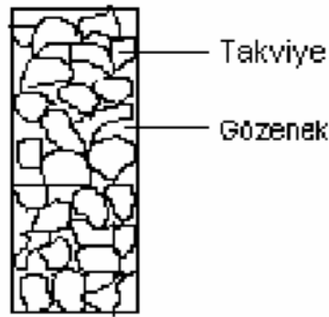
Şekil 2.9. Takviye tozlarının cam kap içerisinde oluşturdukları dolu hacim ve gözenekler [6]
