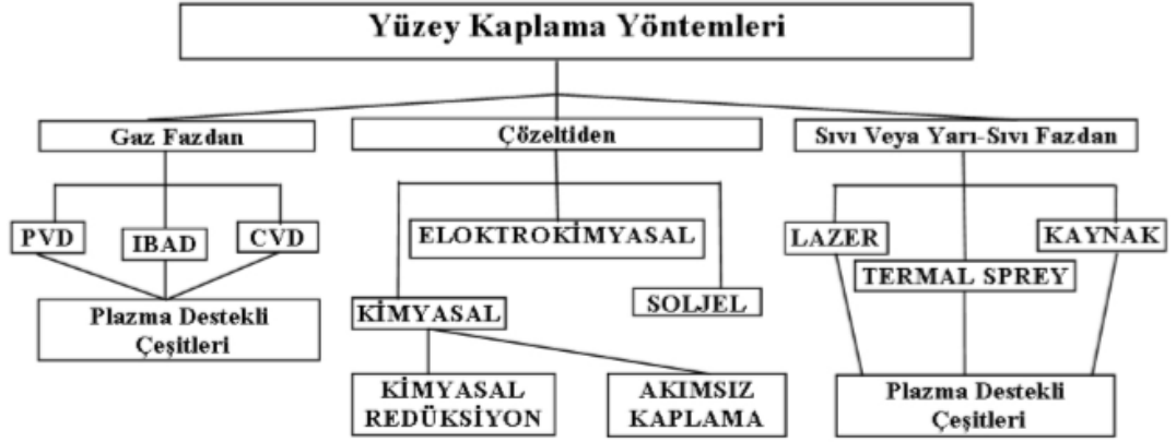
Şekil 2.13. Kaplanacak malzemenin bulunduğu fiziksel hale göre kaplamaların sınıflandırılması [68].
