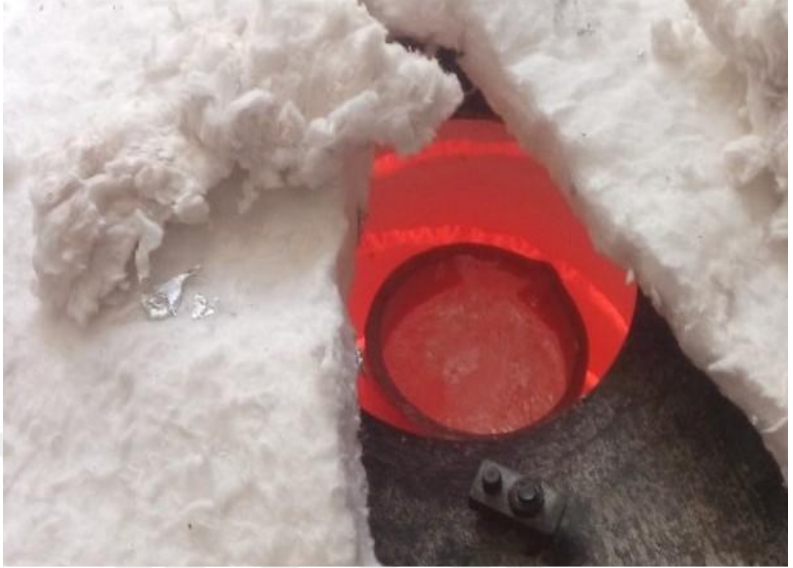
Şekil 3.9. Ergitilmiş AA 1070 alaşımı
