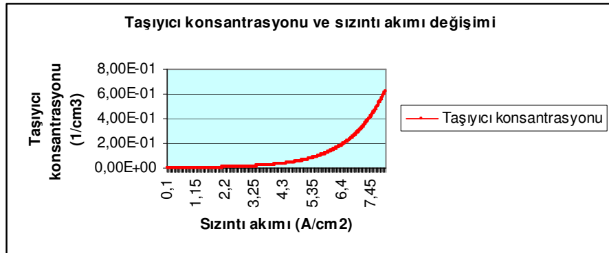
Şekil.3.7.11. Taşıyıcı konsantrasyonu' na göre sızıntı akımı değişimi
