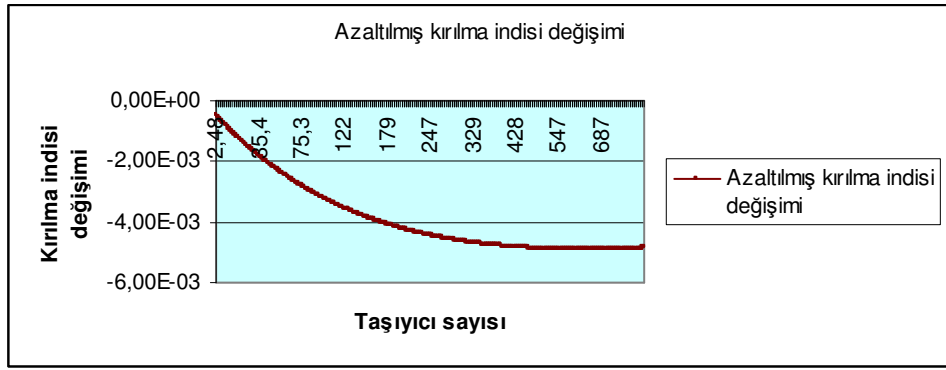
Şekil.3.7.10. Taşıyıcı sayısına göre azaltılmış kırılma indisi değişimi
