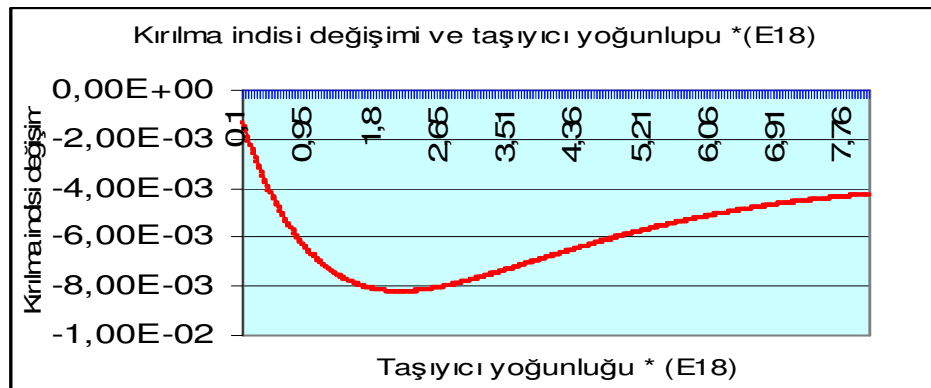
Şekil 3.1.17. Kırılma indisi değişimi ve taşıyıcı yoğunluğu ilişkisi
