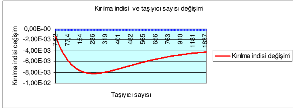
Şekil 3.4.13. Taşıyıcı sayısı ve kırılma indisindeki değişme ilişkisi
