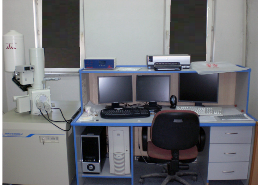
Şekil 2.7. JEOL JSM-6390L model taramalı elektron mikroskobu.
