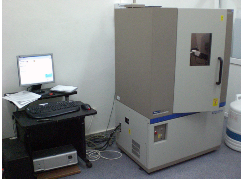
Şekil 2.8. Kırınım desenlerinin belirlenmesinde kullanılan Rigaku Multiflex marka XRD cihazı.
