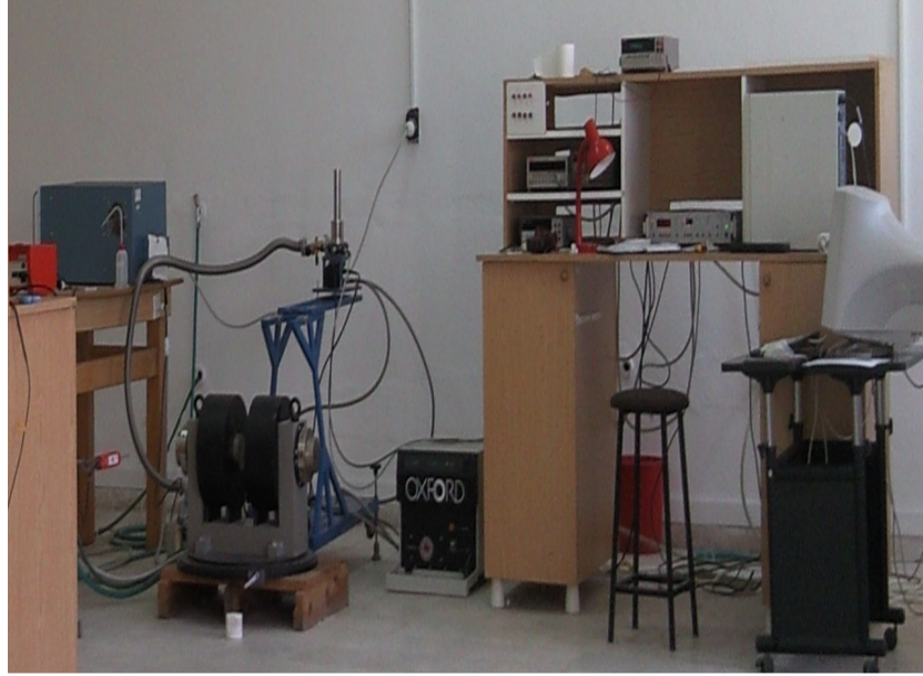
Şekil 2.6. Özdirenç ölçümlerinin yapıldığı Oxford marka kapalı devre sıvı helyum kriyostat sistemi.
