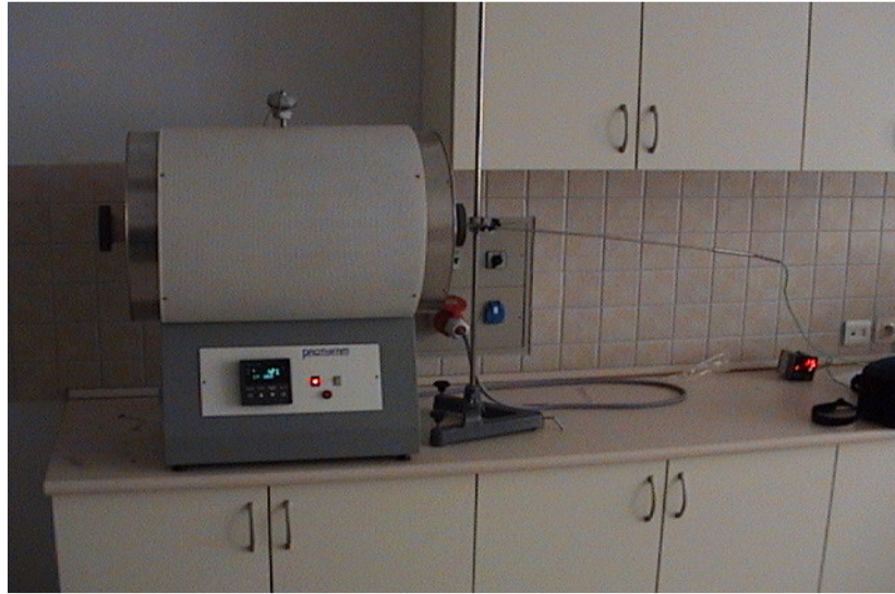
Şekil 2.1. Protherm marka silindirik fırın ve K-tipi ısı çift sıcaklık ölçer.
