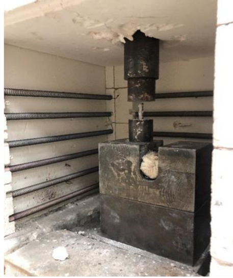
Resim 4.3. Kalıplama ile kompozit üretimi
