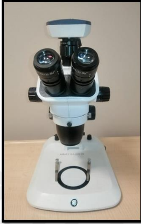
Şekil 3. 10. Mikrosızıntı deneyinde kullanılan stereomikroskop (EUROMEX Nexius Zoom, Arnhem, Holland)
