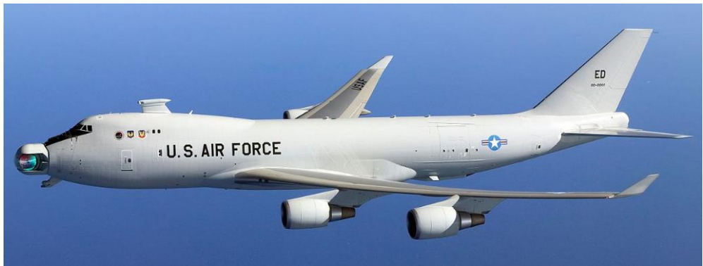
Şekil 2.2. Boeing YAL-1. Lazer sistemi, uçak burnuna tutturulan bir döner başlığa monte edilir.
