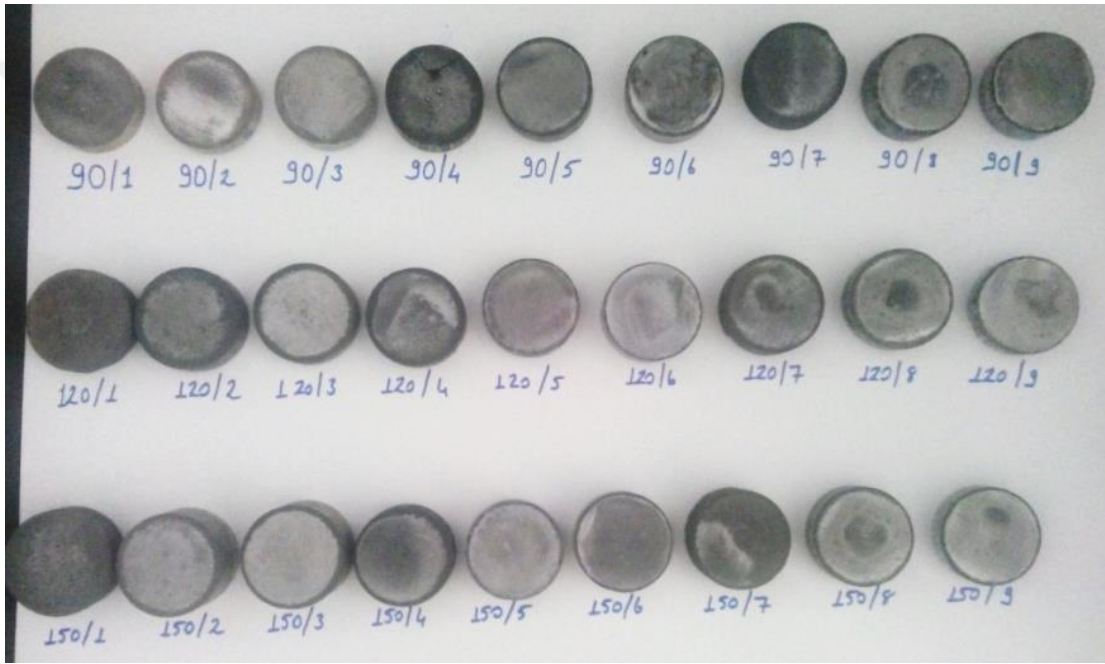
Şekil 5.1. Üretimi tamamlanan SiC ve B 4 C takviyeli kompozit numuneler
