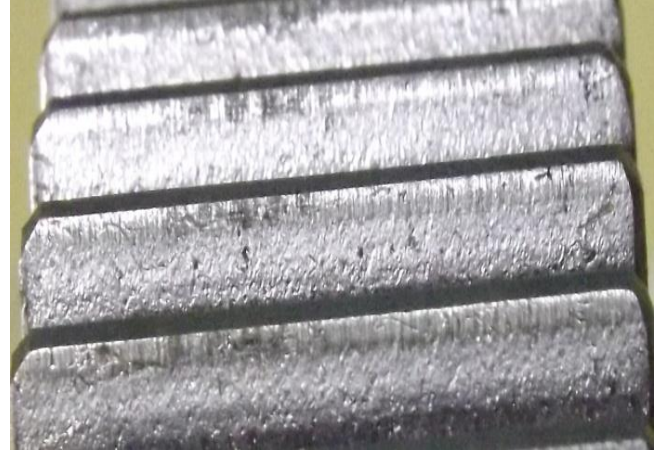
Şekil 10: Deneysel çalışmada kullanılan aşınmış dişli yüzeyi.
