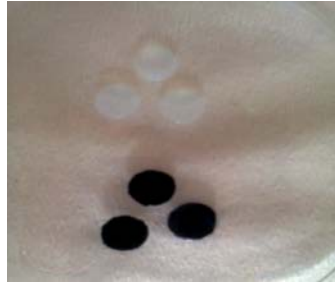
Şekil 2. Hidrojellerin boya adsorpsiyonundan önce ve sonraki görüntüleri
