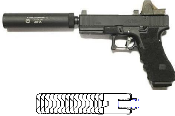
Şekil 3. Susturucunun montajı ve kesit görünüşü (Silencers, 2018).
