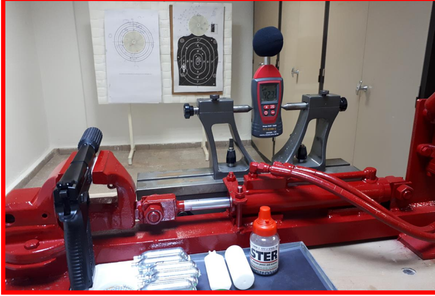
Şekil 7. Atış test ve ses seviyesi ölçüm düzenneđi
