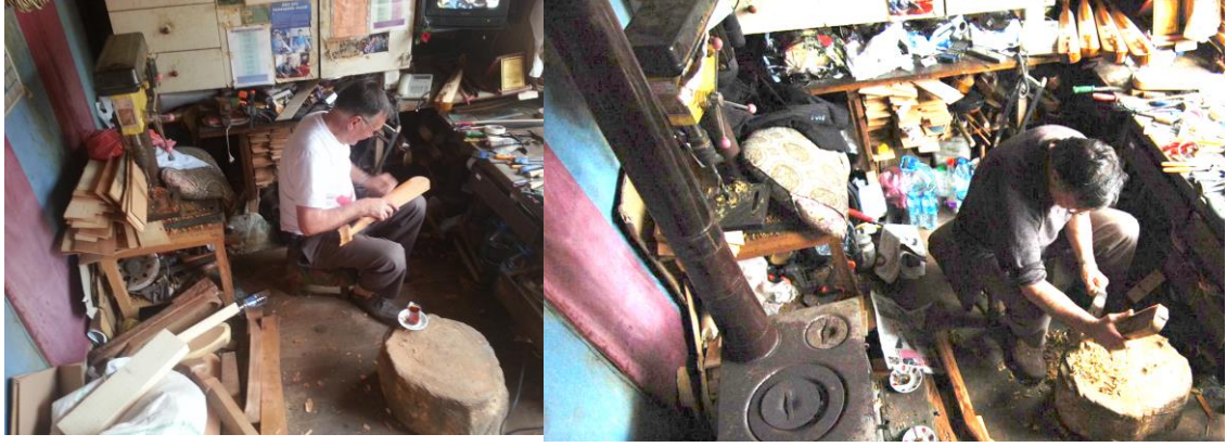
Fotoğraf 15: Kemeçe yapım ustası Hasan SANCAK (Sadece Keser ve Kırık Cam Şişe ile Karadeniz Kemeçesi Yaparken, 2010)
