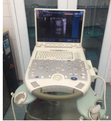
Şekil 2.2. Esaote MyLab® 30 Vet(İtalya) dijital renkli dopplerli ultrasonografi ve ekokardiyografi cihazı
