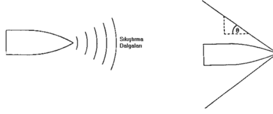
Şekil 4.6 Ses Hızı Altı (Solda) ve Ses Hızı Üstü Bölgede (Sağda) Hava Sıkışması Sonucu Oluşan Basınç Dalgalarının Hareket Tarzları
