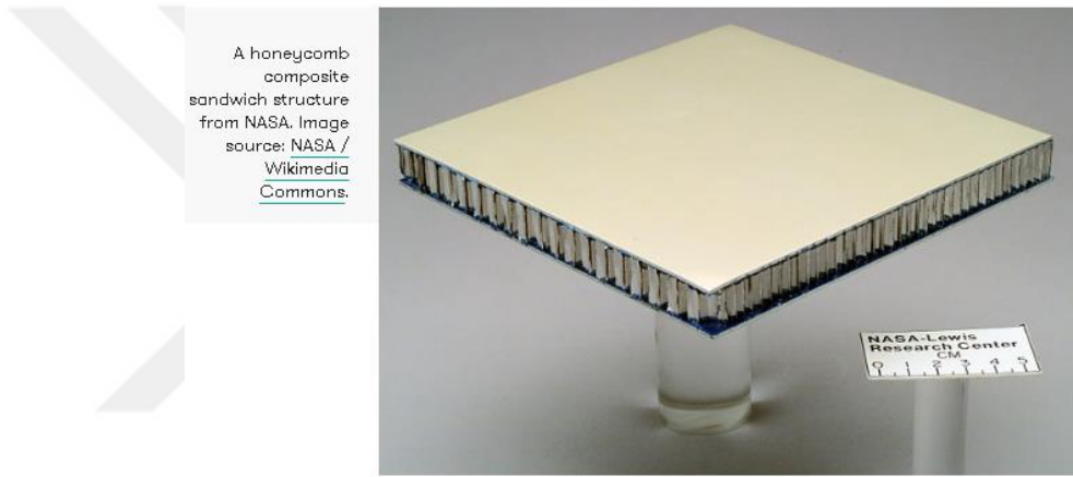
Şekil 3.3 Nasa tarafından imal edilen bir honeycomb kompoziti [20].
