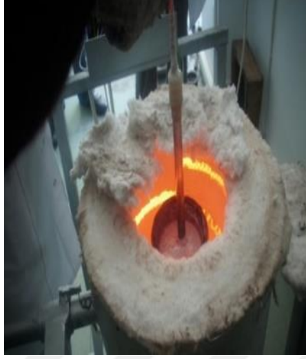
Şekil 4. 3. Vakum infiltrasyonun yapıldığı ergitme ocağı.
