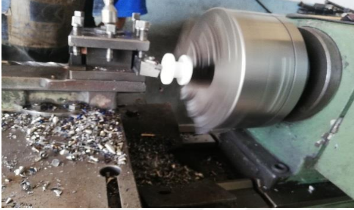
Şekil 4.5 Tornada Makaranın İşlenmesi
