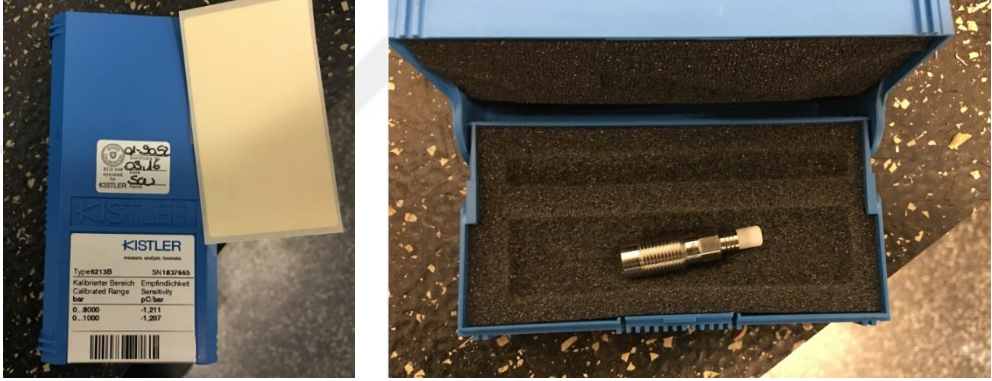
Şekil 3.4. Kistler Basınç Sensörü
