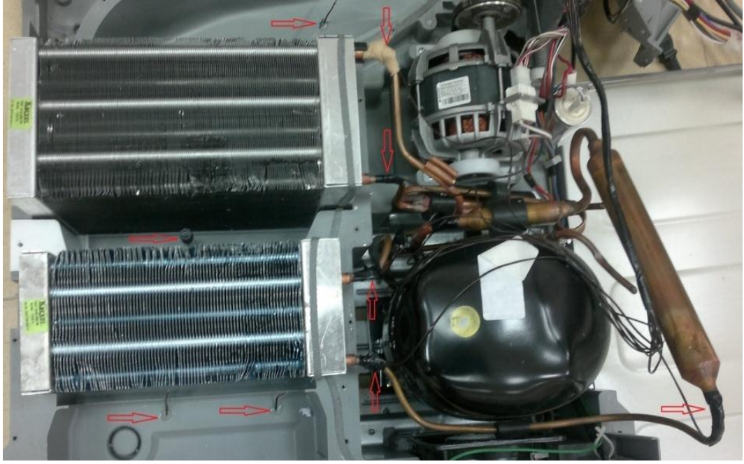
Şekil 3.11. Bazı nem ve sıcaklıkölçerler ile termoelemanların ısı pompası üzerindeki konumları
