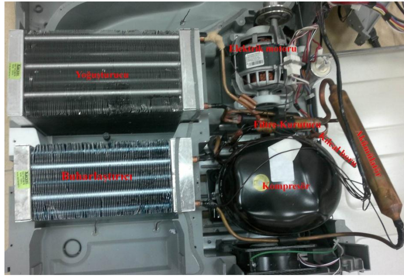
Şekil 3.2. Kurutma makinesinde yer alan ısı pompasının elemanları
