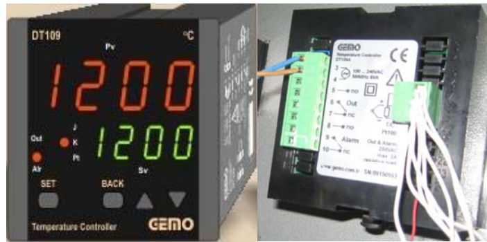
Şekil 7.6. DT109 dijital sıcaklık okuyucu ve bağlantıları
