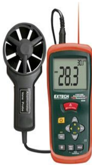
Şekil 7.10. Thermo–Anemometre (Extech AN200 Pervane Tipi)
