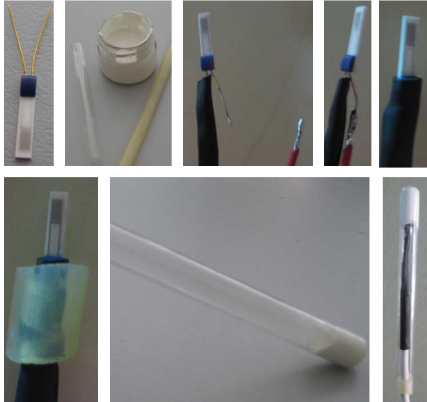
Şekil 7.8. Sıcaklık algılayıcı imalat aşamaları
