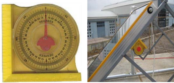
Şekil 7.11. Açı ölçer ve kollektöre montajı
