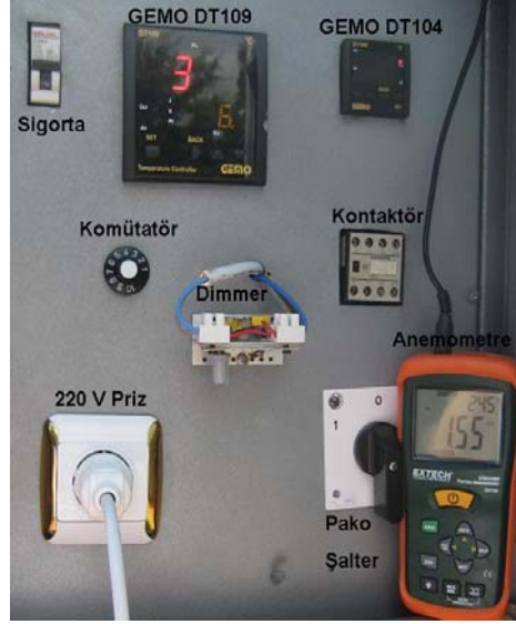
Şekil 7.5. Pano yerleşim detayı
