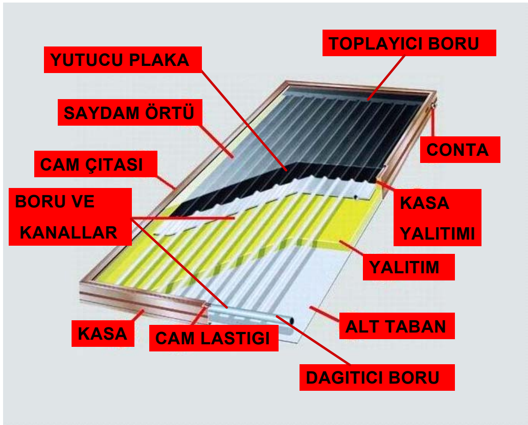
Şekil 4.1. Düz güneş kollektörü şeması
