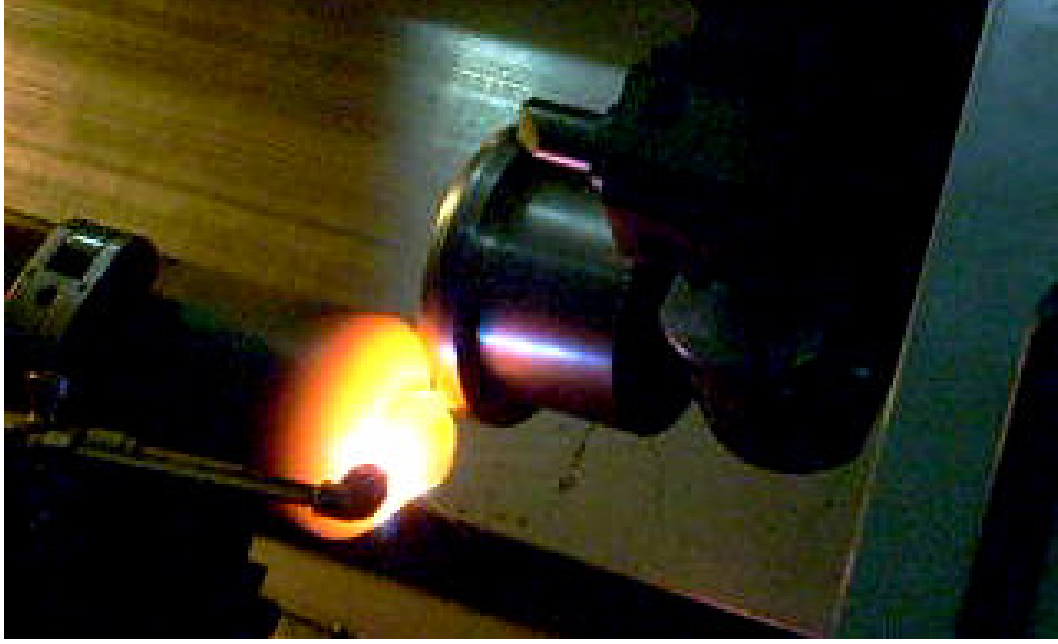
Şekil 2.2. Sıvama yöntemi ile dolum ağızı oluşturma işlemi
