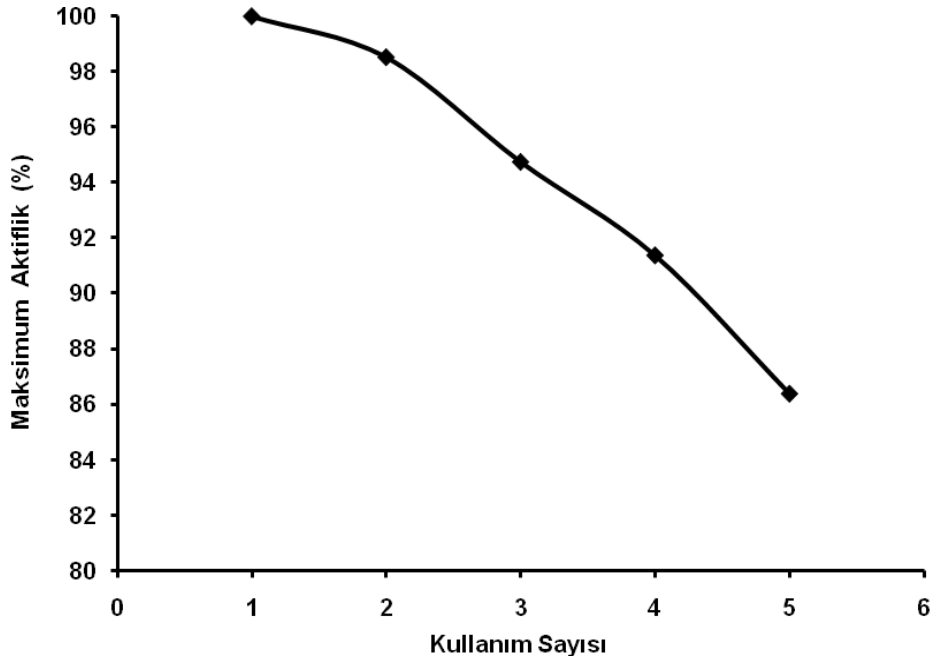
Şekil 3.31. Karbodiimit ve hidrosisüksinimitle aktifleştirilmiş PVA-CaAlj hidrojel kürelerine immobilize edilen lakkazın aktifliğine kullanım sayısı ile değişimi
