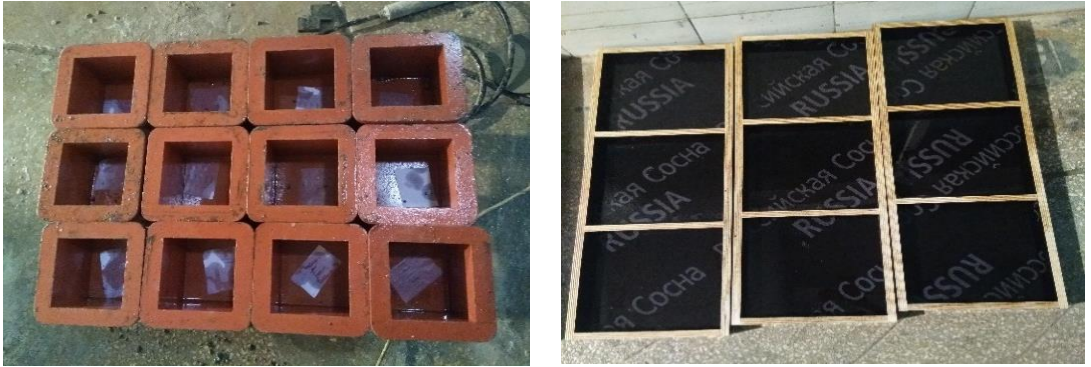
Şekil 3.8. Beton numune üretiminde kullanılan kalıplar
