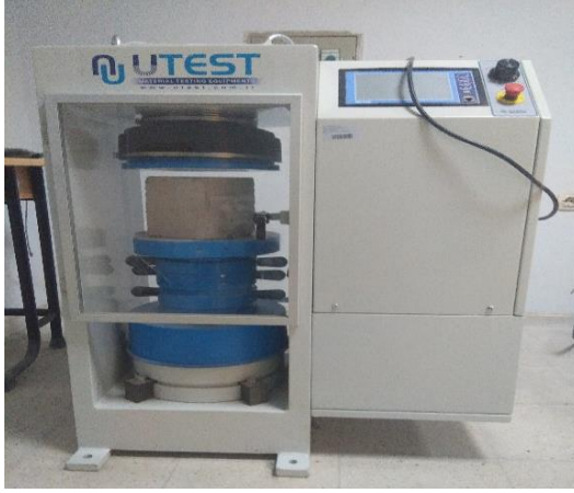
Şekil 3.10. Çalışmada kullanılan beton presi
