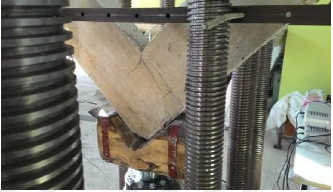
Şekil 3.7. 60 kN yükte oluşan çatlaklar
