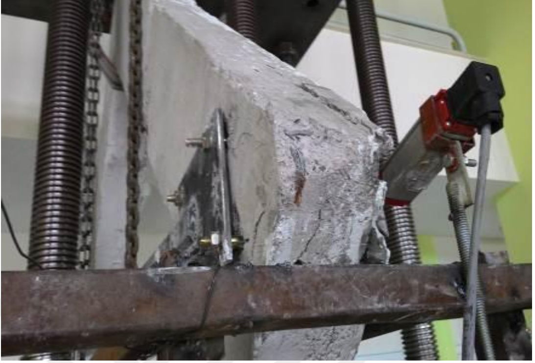
Şekil 3.31. Birleşim bölgesinde oluşan hasar
