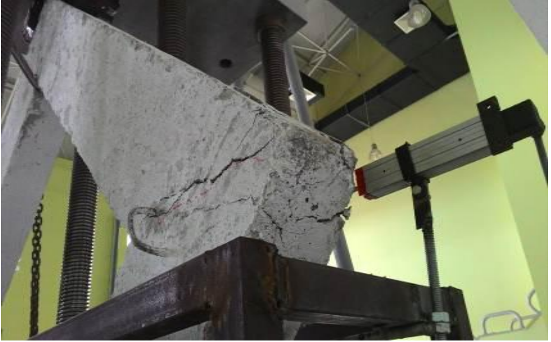
Şekil 3.3. Göçme anında oluşan hasar
