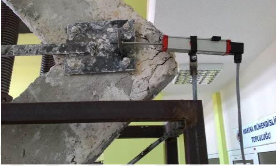
Şekil 3.18. Göçme anında oluşan çatlaklar
