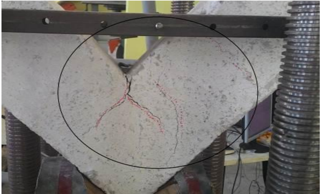
Şekil 3.5. Göçme anında oluşan hasar
