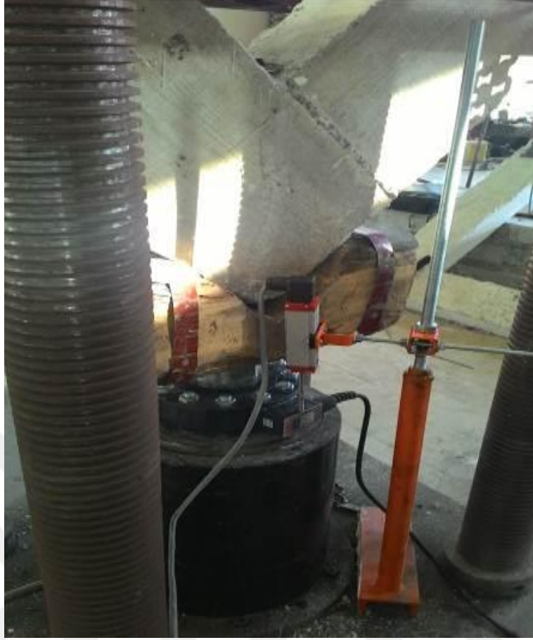
Şekil 2.17. Yük hücresinin montajı ve mesnetlenme durumu
