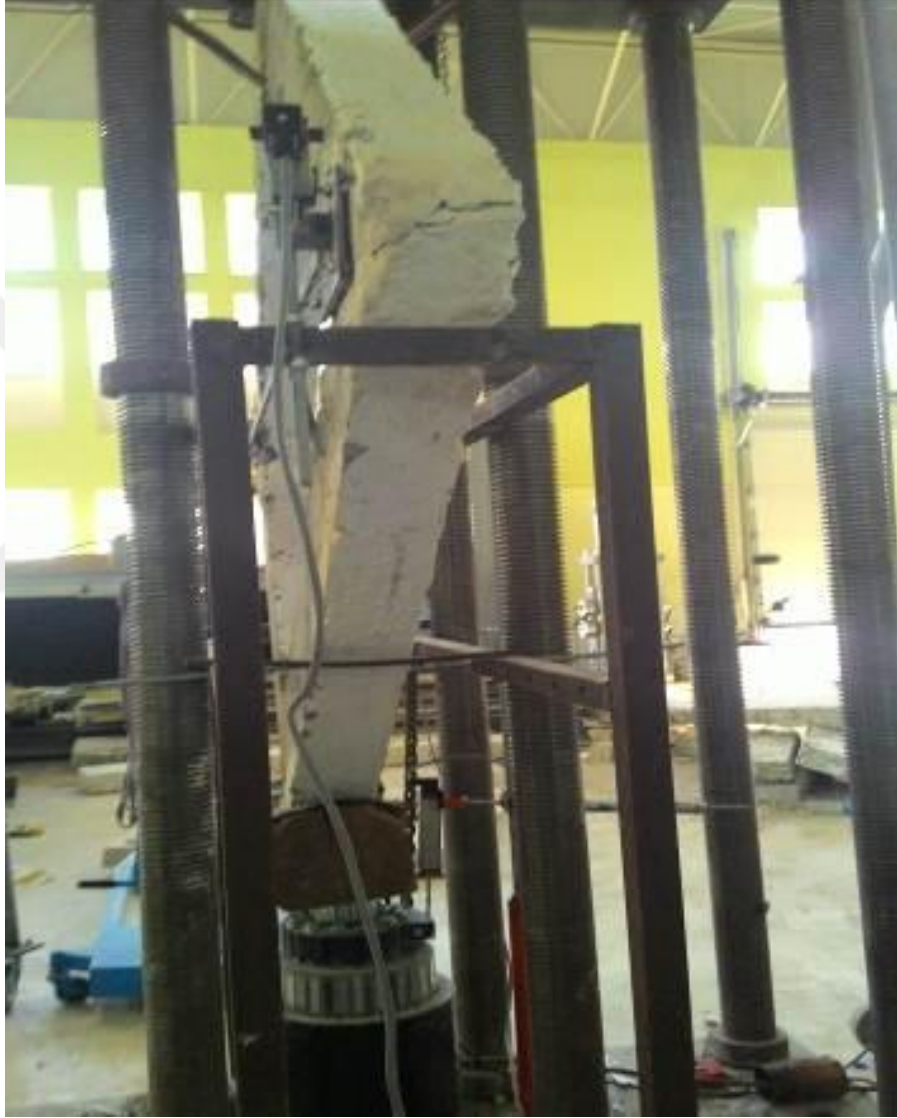
řekil 2.19. erevenin mesnetlenmesi ve profillerle ereve ve LVDT'lerin sabitlenmesi
