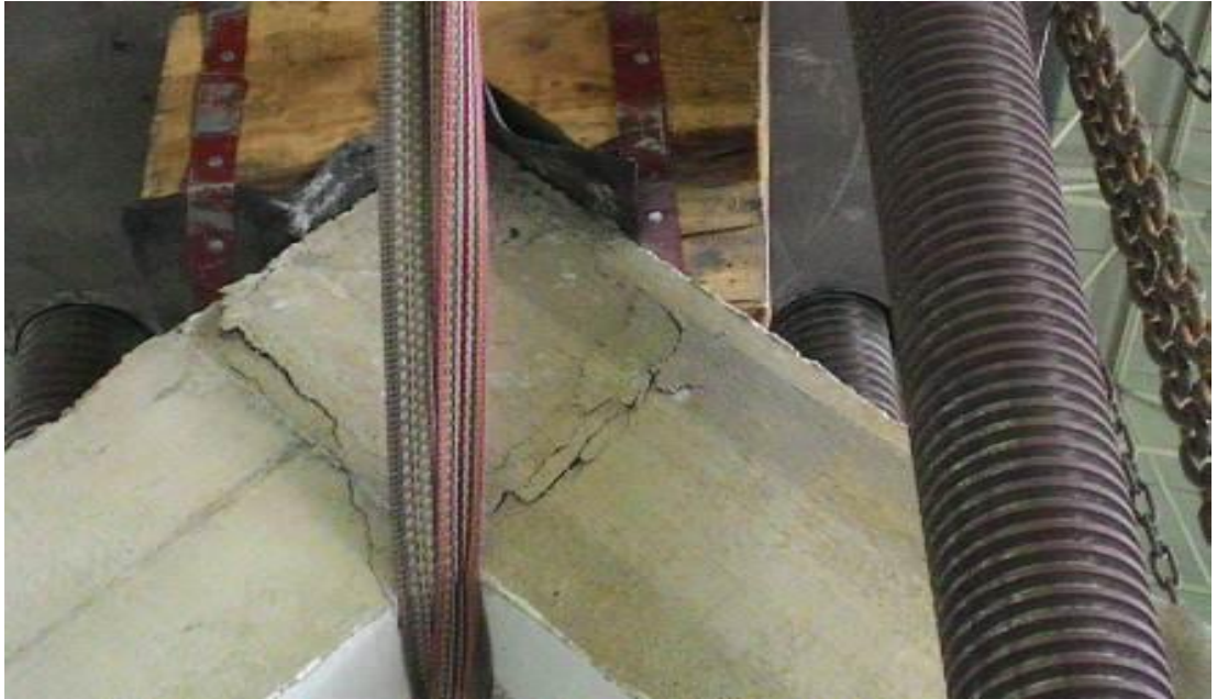
Şekil 3.10. 99 kN yükte oluşan hasar
