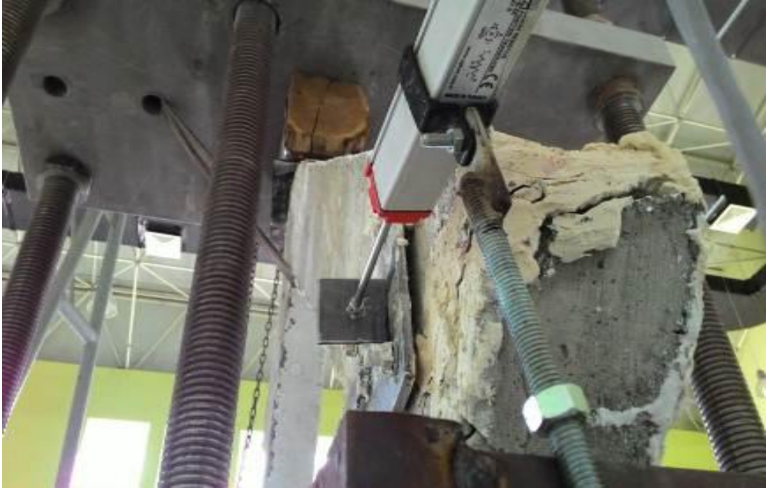
Şekil 3.19. Göçme anında oluşan hasar
