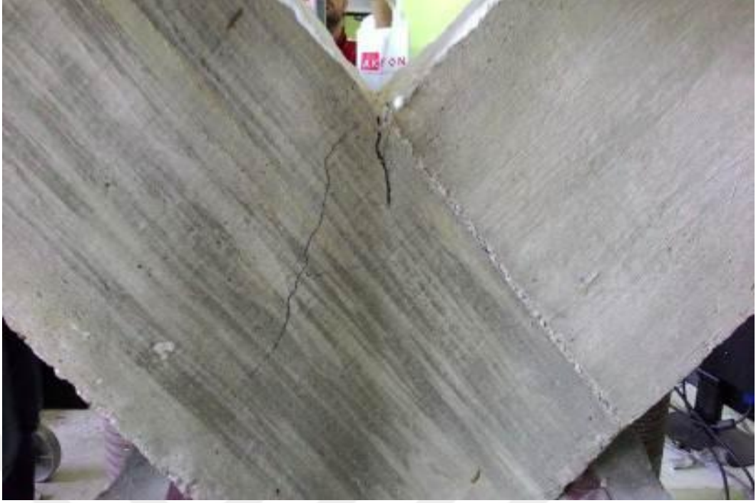
Şekil 3.12. 57 kN yükte oluşan çatlaklar
