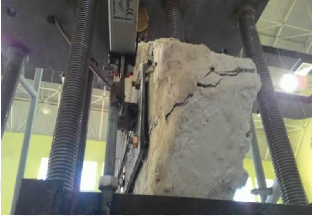
Şekil 3.24. 50 kN yükte oluşan çatlaklar
