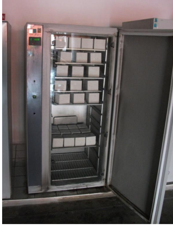
Şekil 3.12. Numunelerin etüvde bekletilmesi
