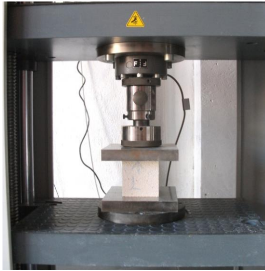
Şekil 3.11. Basınç deneyinin yapılması
