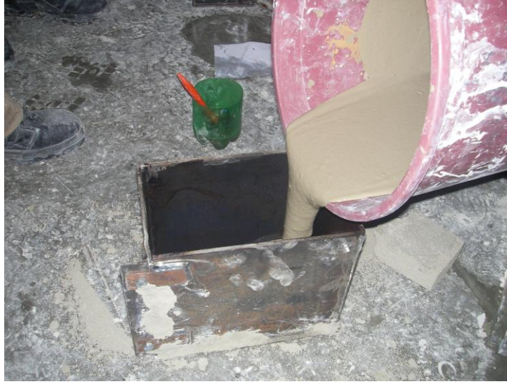
Şekil 3.7. Karışımın numune kaplarına dökülmesi
