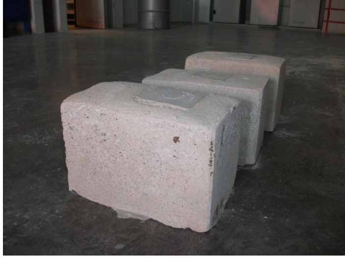
Şekil 3.9. Otoklavdan çıkan deney numuneleri
