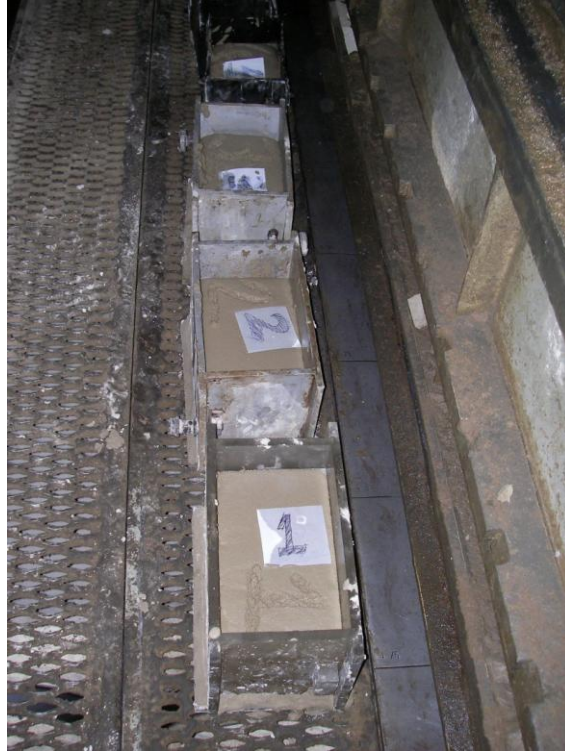
Şekil 3.8. Deney numunelerinin buhar küründe kabarması
