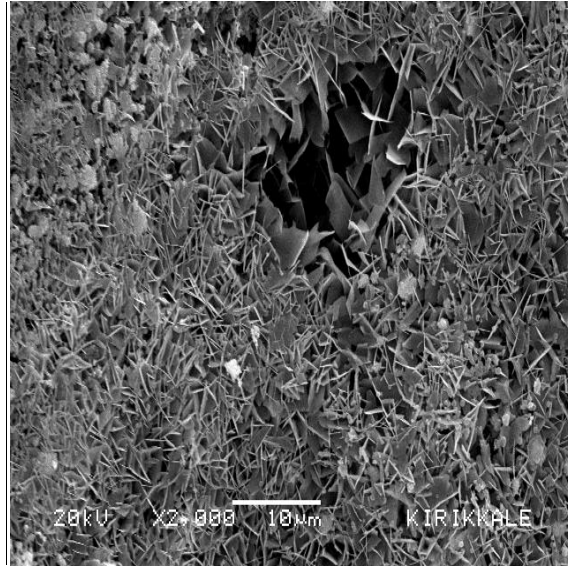
Şekil 4.11. %10 Uçucu kül ikameli gazbetonun SEM görüntüsü ( X 2000)
