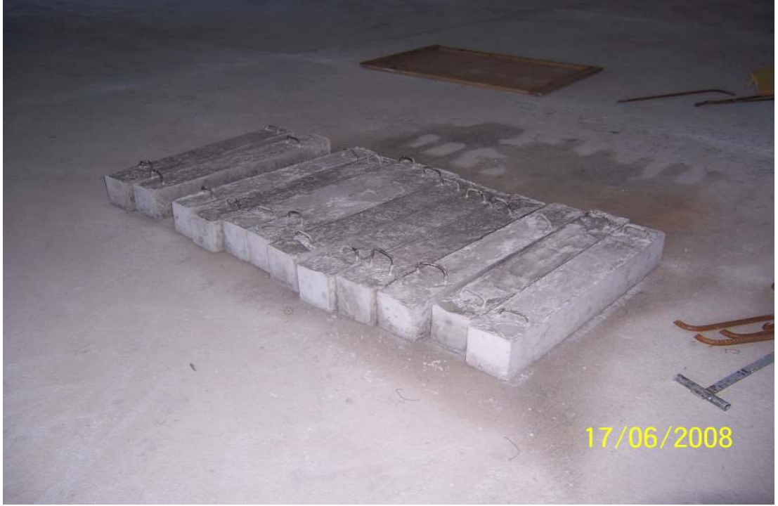
Şekil 2.12. Beton Numunelerin K rlenmesi
