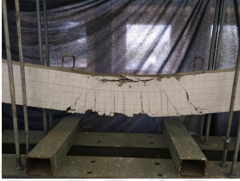
Şekil 2.22. NB3S2 (B10S10) Çatlak Gelişimi
