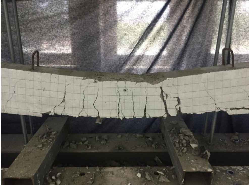
Şekil 2.16. HB3S2 (B10S10) Kirişi Çatlak Gelişimi
