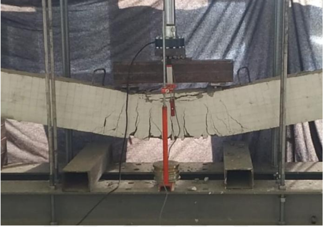
Şekil 2.25. NB2S3 (B10S12) Çatlak Gelişimi
