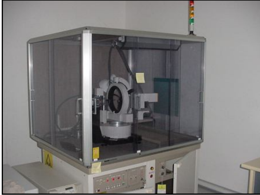
Şekil 2.7. RIGAKU AFC7S Tek Kristal Difraktometresi
