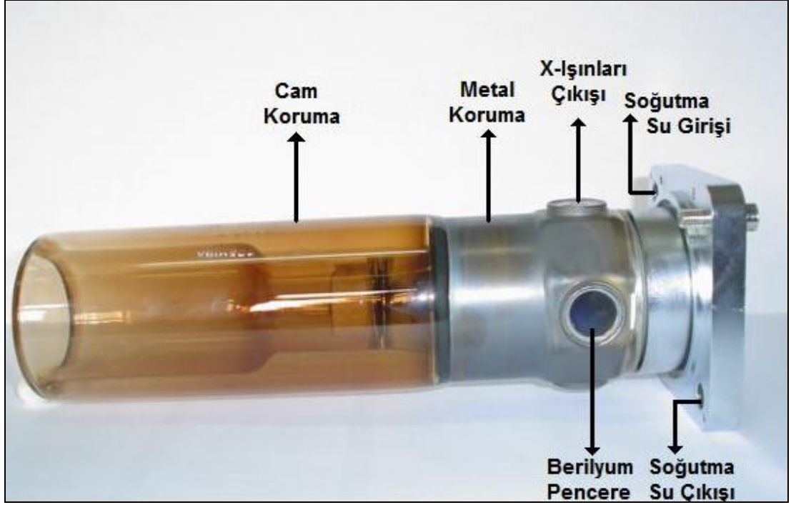
Şekil 2.9. X-Işınları Tüpü (Toshiba)
