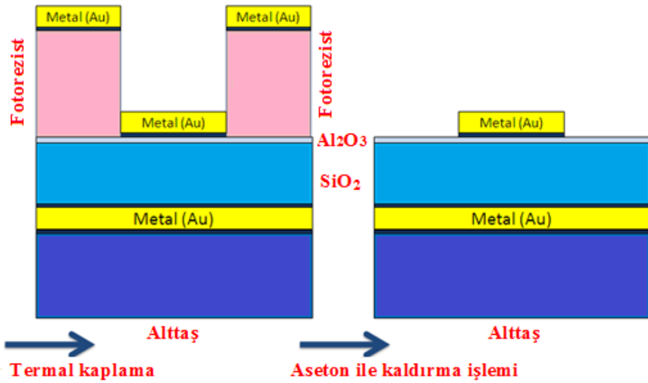
Şekil 2.13. Kaldırma işlemi ve sonrasında sensörün şekli [27]
