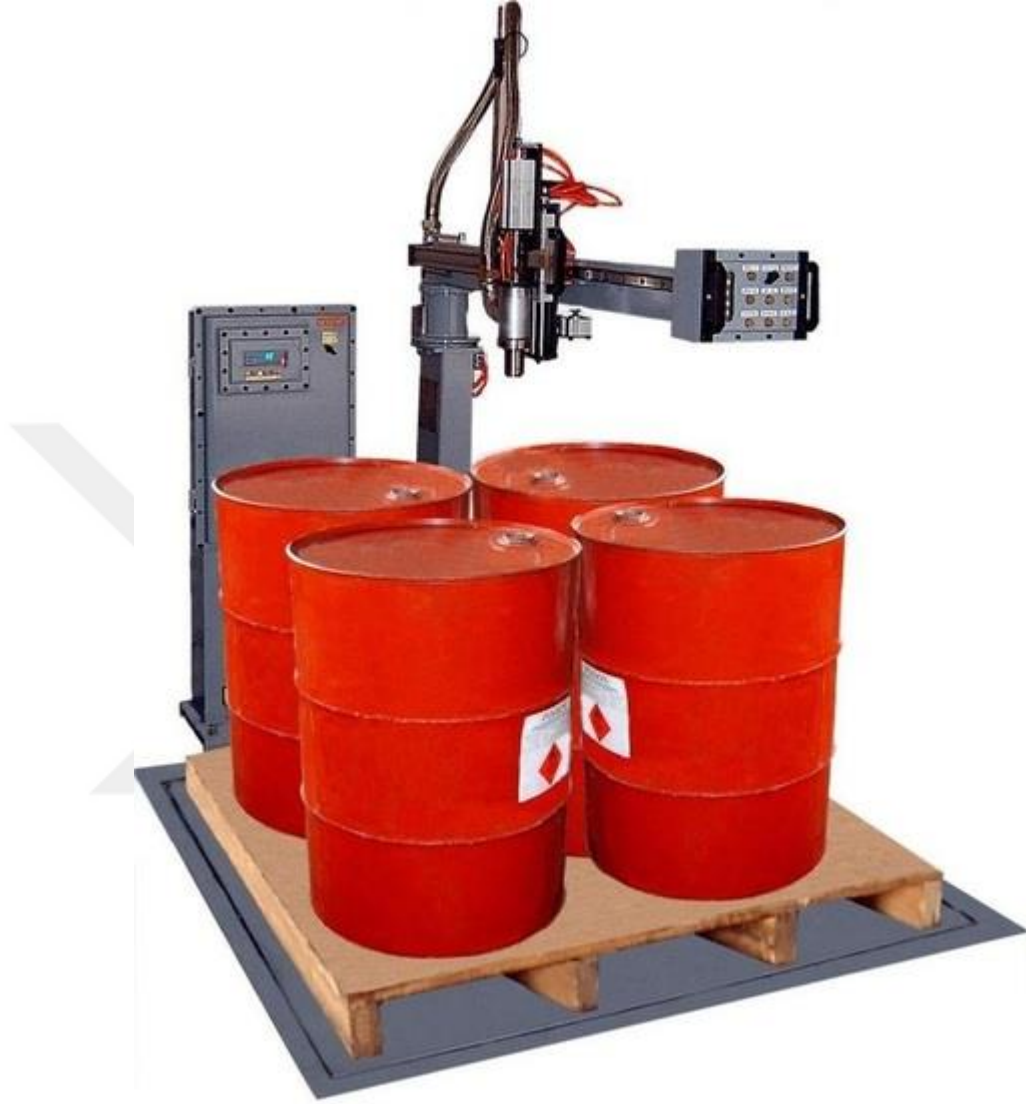
Şekil 5.7 Madeni yağ 200kg Fıçı dolum makinası görseli
