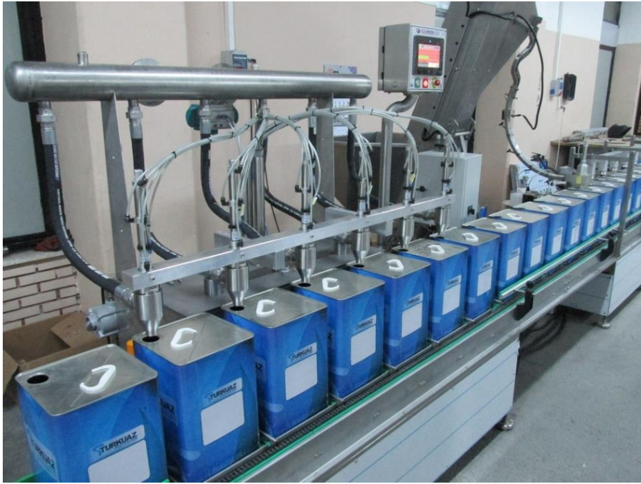
Şekil 5.6 Madeni yağ 16kg teneke dolum makinası görseli
