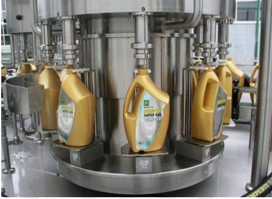
Şekil 5.5 Madeni yağ 4lt şişe dolum görseli
