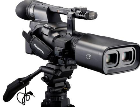
Şekil 1.9 Çift Lensli Stereskopik Kamera [11].
