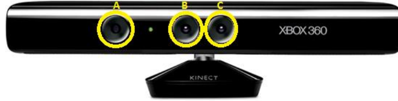
Şekil 1.13 Kinect: (A) Kızılötesi kaynak, (B) 2B Kamera, (C) Derinlik kamerası[19].
