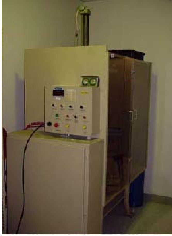
Şekil 3.10. Isıl şok testi test ekipmanı
