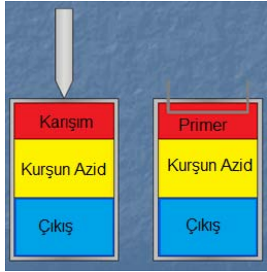
Şekil 1.28. Delme ile patlayıcı aktivasyonu [23]
