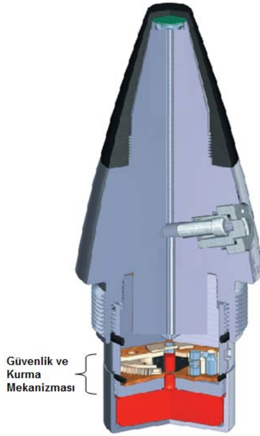
Şekil 2.2. Güvenlik ve kurma mekanizmasının tapa üzerindeki yeri
