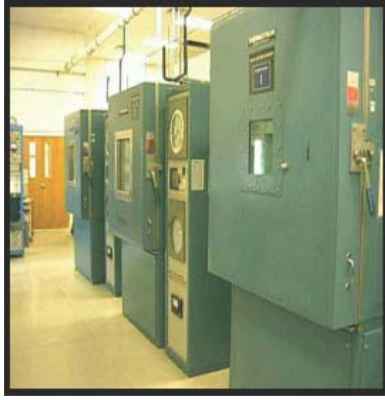
Şekil 3.9. Tuz sisi testi test ekipmanı [54]
