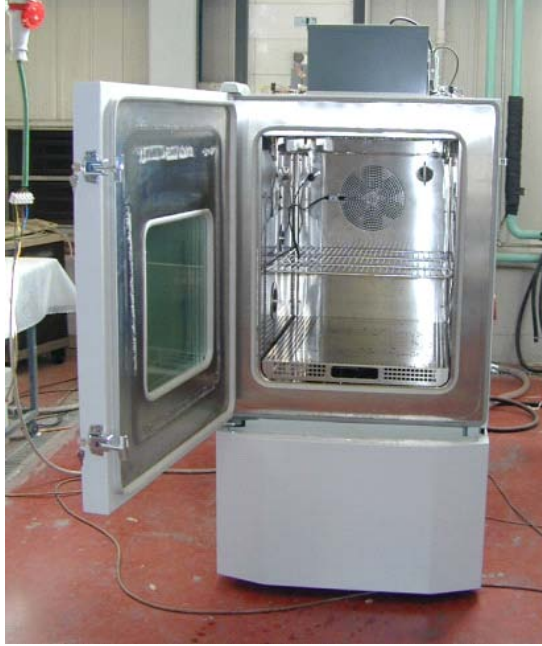
Şekil 3.12. Solar radyasyon test ekipmanı
