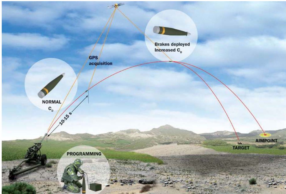
Şekil 1.10. Junghans firması yapımı ECF marka kumanda edilebilir tapa [17]
