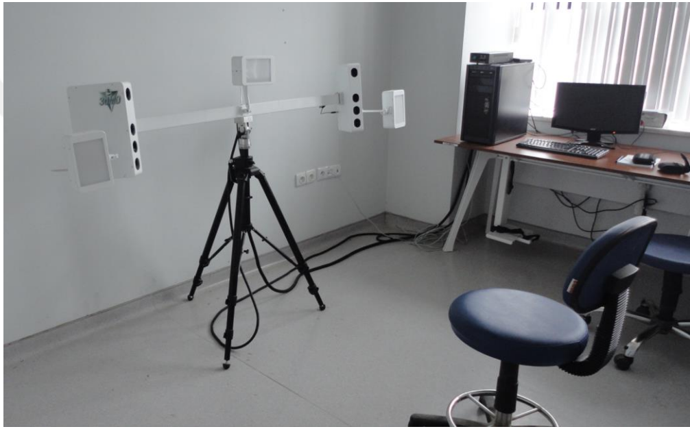
Şekil 2.1. “3dMD Face” (3dMD TM Ltd, Atlanta, GA, ABD) görüntüleme sistemi
