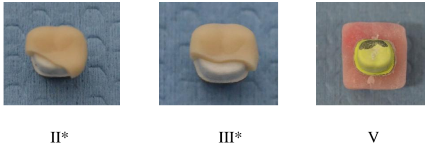
Şekil 3.12 Termal döngü uygulanan Pr grubu kronlara ait kırık şekillerinin örnekleri (*Termal döngü sırasında oluşan kırık şekilleri)
