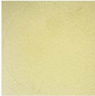
Şekil 3.22 Lava Ultimate materyaline ait kumlama+silan grubunun adeziv kırılma türü
