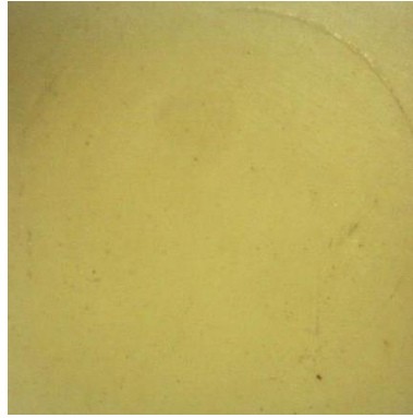
Şekil 3.10 Vita Enamic materyaline ait kontrol grubunun adeziv kırılma türü
