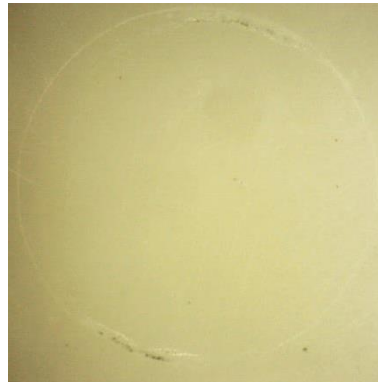
Şekil 3.19 Lava Ultimate materyaline ait kontrol grubunun adeziv kırılma türü
