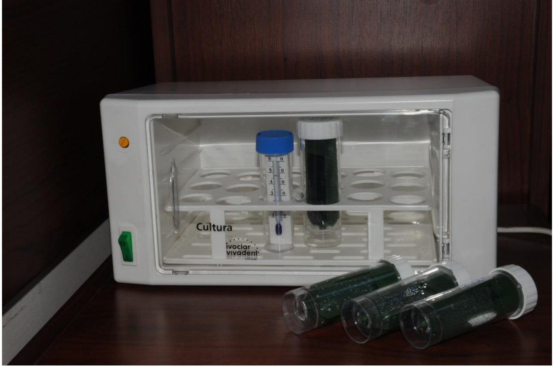
Şekil 2-4 İnkübatörde 37 °C'de 48 saat bekletilen CRT bacteria tüpleri
