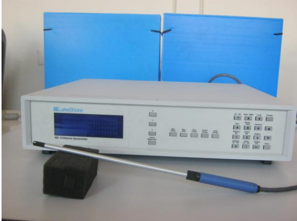
Resim 3.16. Mıknatısların gücünü ölçen Gaussmeter
