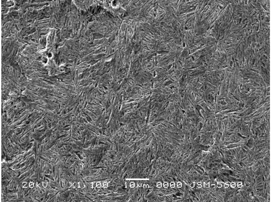
Şekil 3.1. Fe-%3Ni-%0,8Cr-%0,2Mn-%0,2V alaşımında oda sıcaklığında soğutulan numunenin SEM görüntüleri
