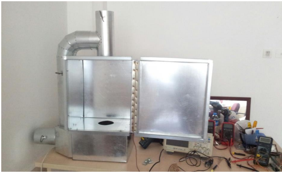
Şekil 2.55. Akıllı otomatik kurutma fırını
