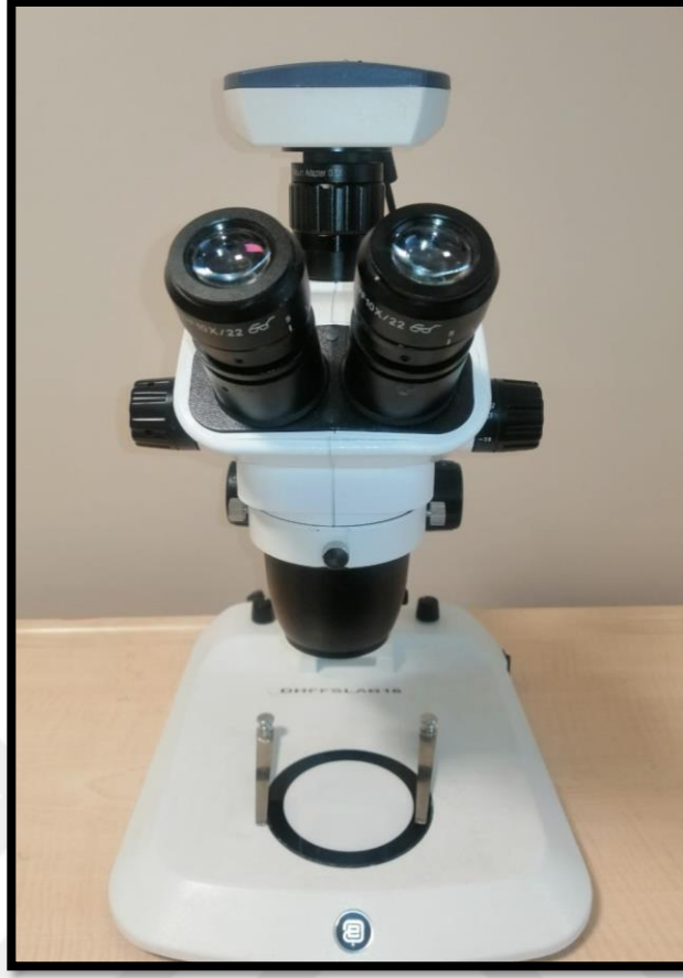
Şekil 3. 10. Çalışmamızda kullanılan stereomikroskop (Nexius Zoom, Euromex, Arnhem, Holland)
