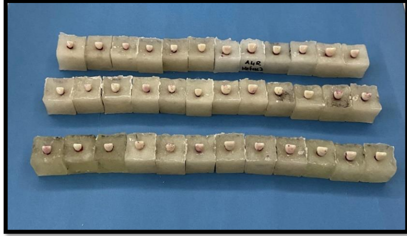
Şekil 3. 8. Hazırlanan akrilik bloklara yerleştirilmiş örnekler
