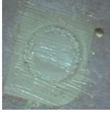
Şekil 3.20. GC Cerasmart çay grubuna ait karışık kırılma türü
