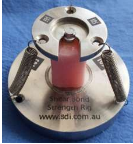
Şekil 2.14. Bir örneğin SDI SBS Rig test aparatındaki görüntüsü
