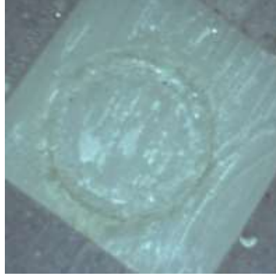
Şekil 3.33. Lava Ultimate kola grubuna ait karışık kırılma türü
