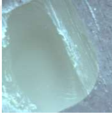
Şekil 3.18. GC Cerasmart kontrol grubuna ait koheziv kırılma türü
