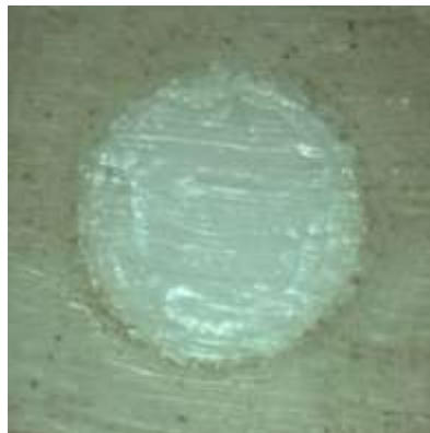
Şekil 3.28. Lava Ultimate kontrol grubuna ait koheziv kırılma türü
