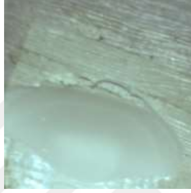
Şekil 3.21. GC Cerasmart çay grubuna ait koheziv kırılma türü
