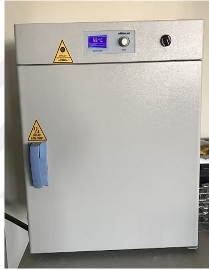
Şekil 5.1 Numunelerin oda sıcaklığında ( 20\pm 2^{\circ}\text{C} ) ve nem altında ( \%95\pm 5 ) kürlenmesi
