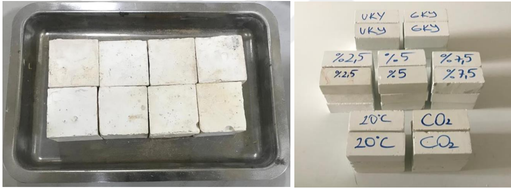
Şekil 3.10 Karışımlarda kullanılan kalıplar ile üretilen numuneler
