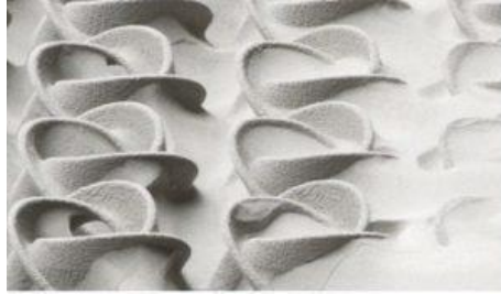
Şekil 1.23: (A) 3 boyutlu baskının ardından toz yatağındaki parçalar (Höganäs AB – Digital Metal®'in izniyle), (B) 3 boyutlu baskı ile yapılmış paslanmaz vidalar (Höganäs AB – Digital Metal®'in izniyle) [58]
