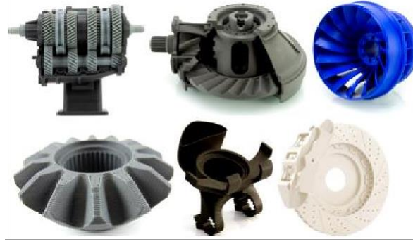
Şekil 1.14: FDM/ Eriyik Biriktirme/Yığıma Modelleme Tekniği Uygulaması [40,41]
