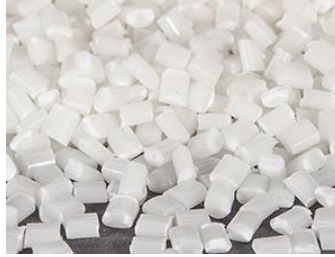
Şekil 1.28: Granül formundaki ABS termoplastik malzemesi [73]
