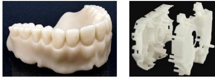
Şekil 1.11: Stereolitografi (SLA) / Tarayarak Işıklı Kütleme Uygulamaları [27]
