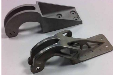
Şekil 1.8: Klasik (üstte) ve Eklemeli İmalat Yöntemleriyle Üretilmiş Uçak Motor Kapağı Menteşesi [17]
