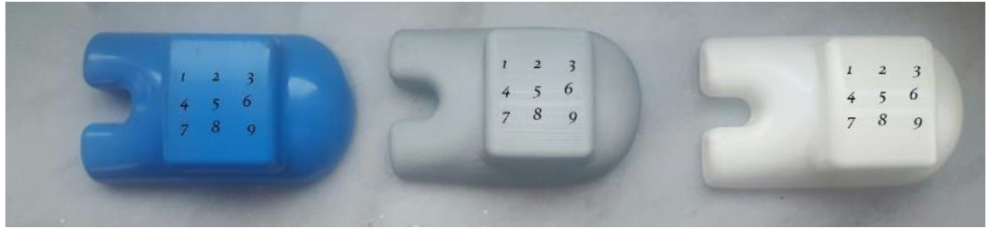
Şekil 2.16: Yüzey pürüzlülüğü ölçüm noktalarının rakamlar ile gösterilmesi
