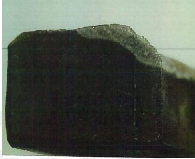
Şekil 8.8. S38815 manuel kaynak 3 makro test görüntüsü
