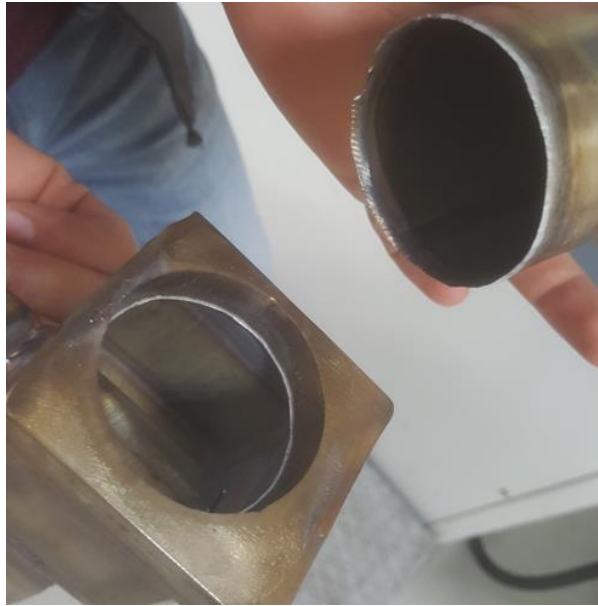
Şekil 8.4. Manuel kaynak çekme testi sonucu kopma
