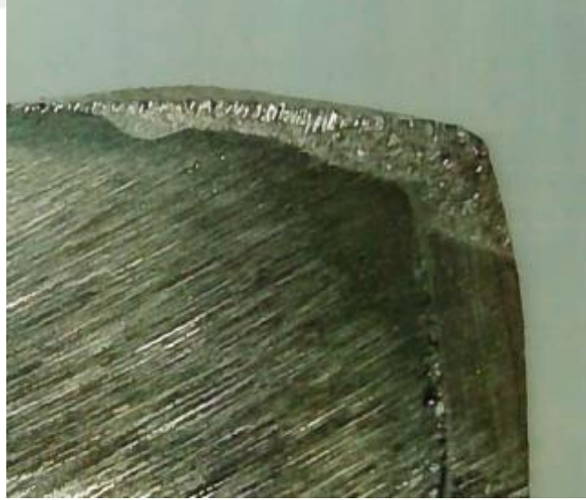
Şekil 8.9. 304L manuel kaynak 9 makro test görüntüsü
