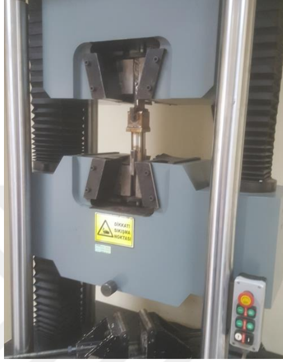
Şekil 8.3. Çekme testi anında malzeme ve cihazın görünümü
