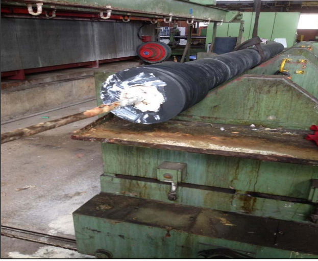
Şekil 7. Yağlaması yapılmakta olan namlu taslağı (Lubrication of the barrel draft)
