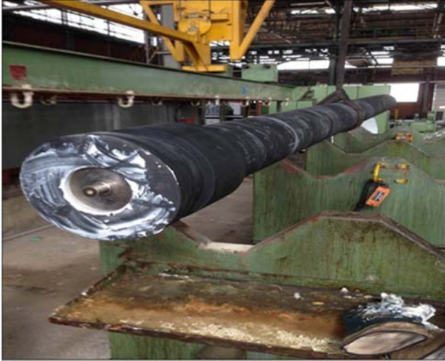
Şekil 8. Mandrel yerleştirilmesi (Placing of the mandrel)
