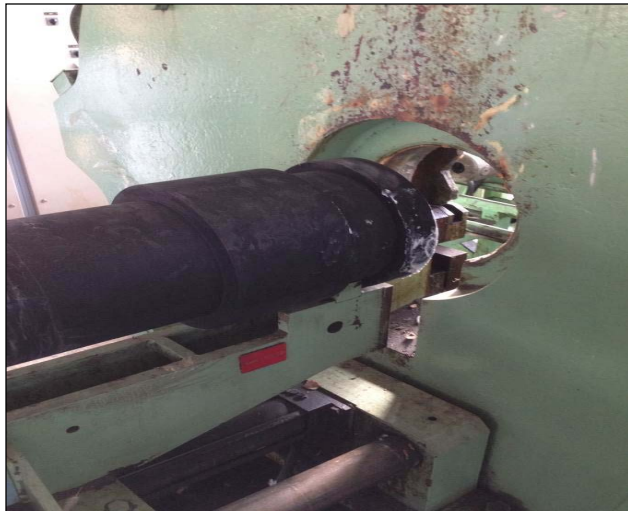
Şekil 9. Tezgâh bağlantılarının gerçekleştirilmesi (Performing the bench connectios)
