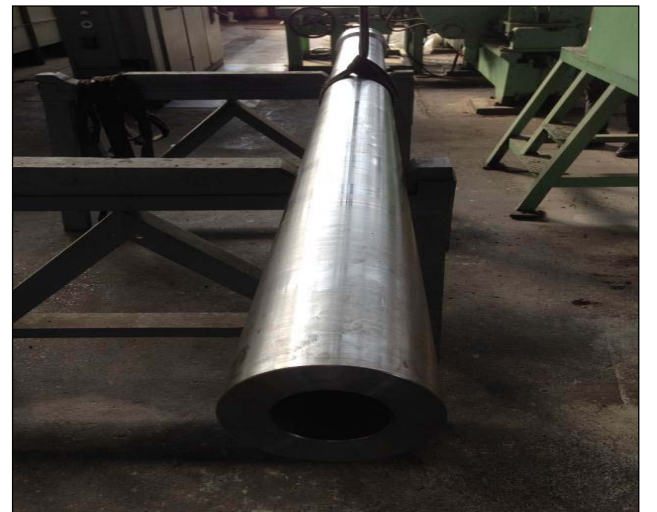
Şekil 6. Otofretaj işlemine hazırlanmış namlu taslağı (Barrel draft prepared to autofrettage process)
