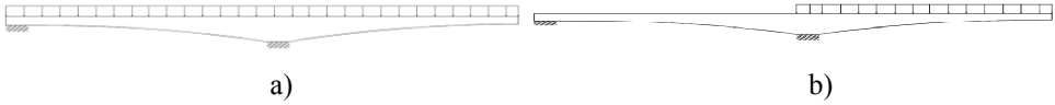
Şekil 20. Köprüde elverişsiz yükleme için, trafik yükü, a) bütün açıklıkta, b) ana açıklık konsolunda
